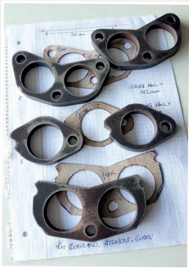
På Gvarv finst einmanns-firmaet AtlasCNC, som kan plasmaskjere eksosflensar til heimelaga racerbilar.
